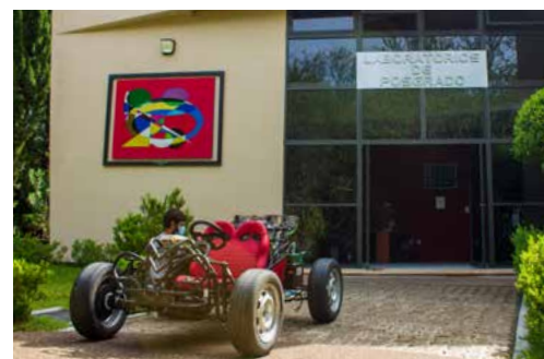
Prototipo de Auto Eléctrico con tracción en las 4 ruedas. Laboratorio de Posgrado, UTM.
