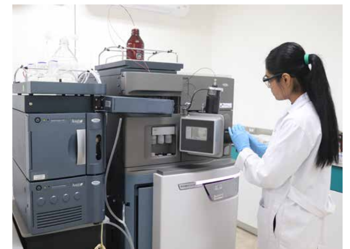
Cromatógrafo de Líquidos acoplado al Espectrómetro de Masas. Instituto de Química Aplicada.
