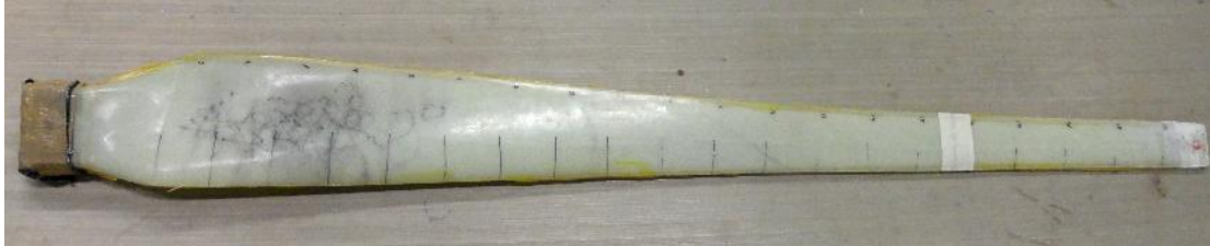
Figura 4.8. Pala manufacturada en fibra de vidrio con perfil aerodinámico S834. Fuente: Elaboración propia.
