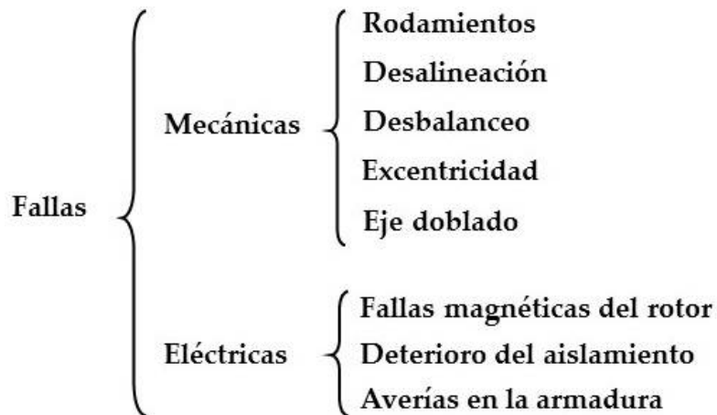
Figura 1.4. Fallas típicas en generadores eléctricos.
