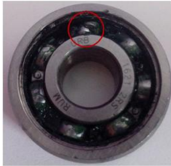
(a) Rodamiento 1621 2RS URB con falla.
