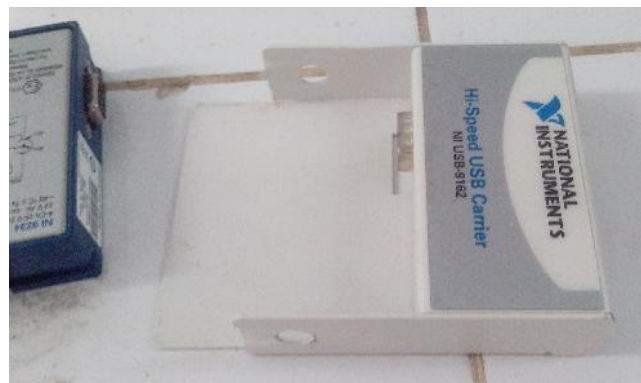
Figura 3.7. Chasis NI USB 9162.
