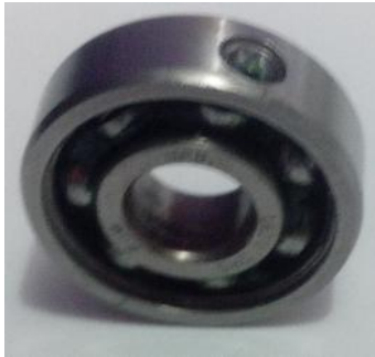
(a) Rodamiento sano 1621 2RS URB.
