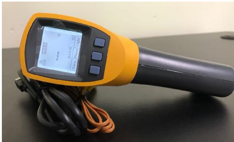
Figura 4.27. Termómetro infrarrojo Fluke® 568 utilizado en las pruebas.
