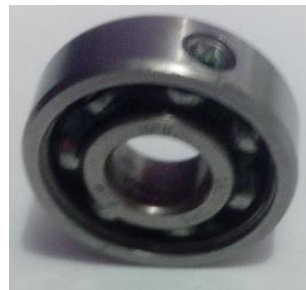
(a) Rodamiento 1621 2RS URB con falla
