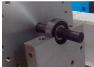
Figura 4.8. Montaje del rodamiento con falla en pista externa.
