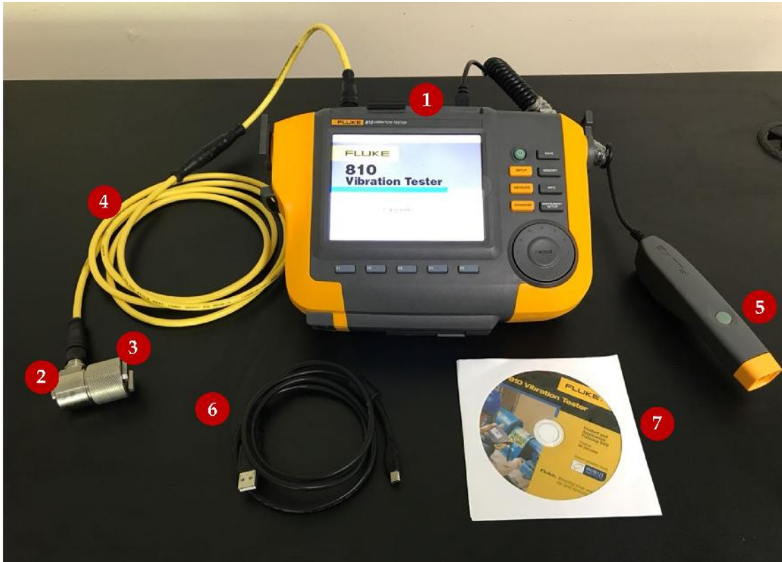
Figura 3.20. Elementos del analizador de vibraciones Fluke® 810.
